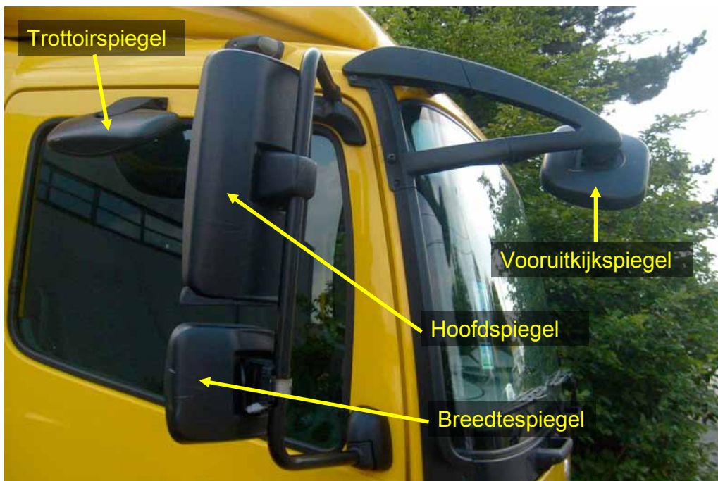
FIGUUR 3 : Opstelling van de spiegels op de rechterspiegel van een vrachtwagen (infografie BIVV)
